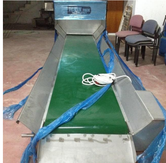
Tapis d'évacuation des déchets
