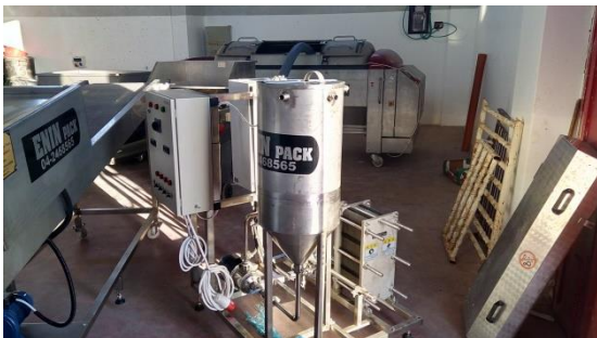
Pasteurisateur et chaudière
